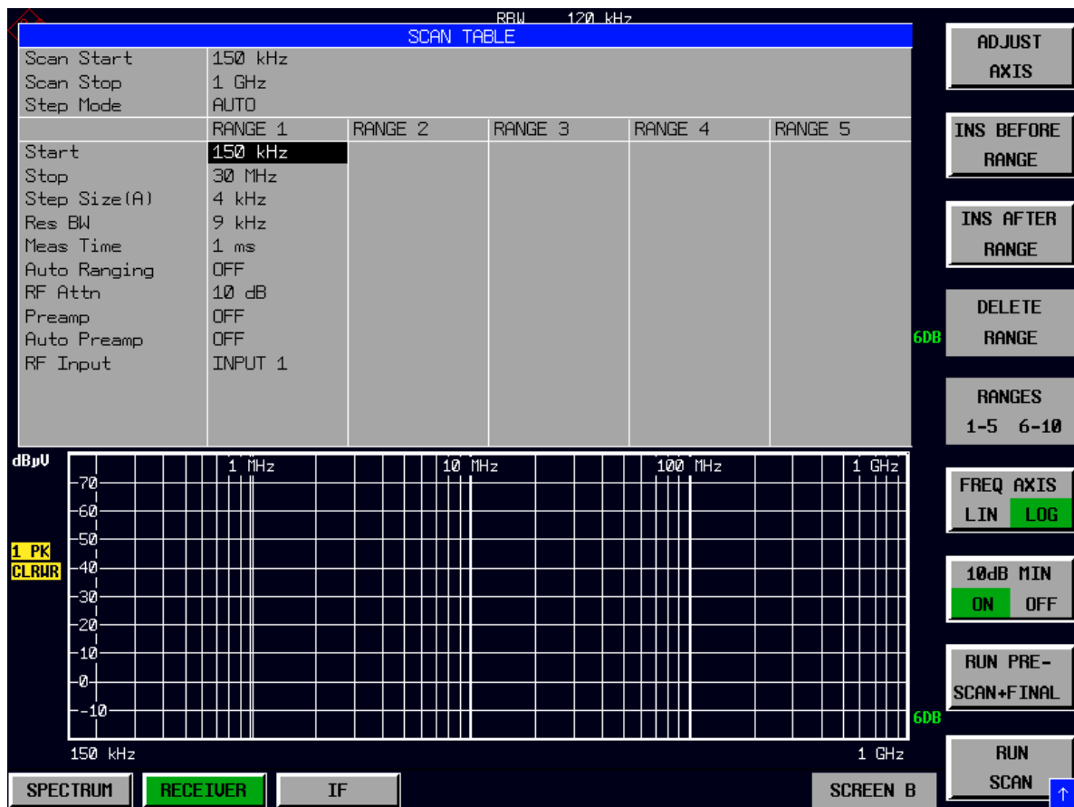
Bild 5-4 Modifizierte SCAN TABLE zur Vorbereitung eines Scans
