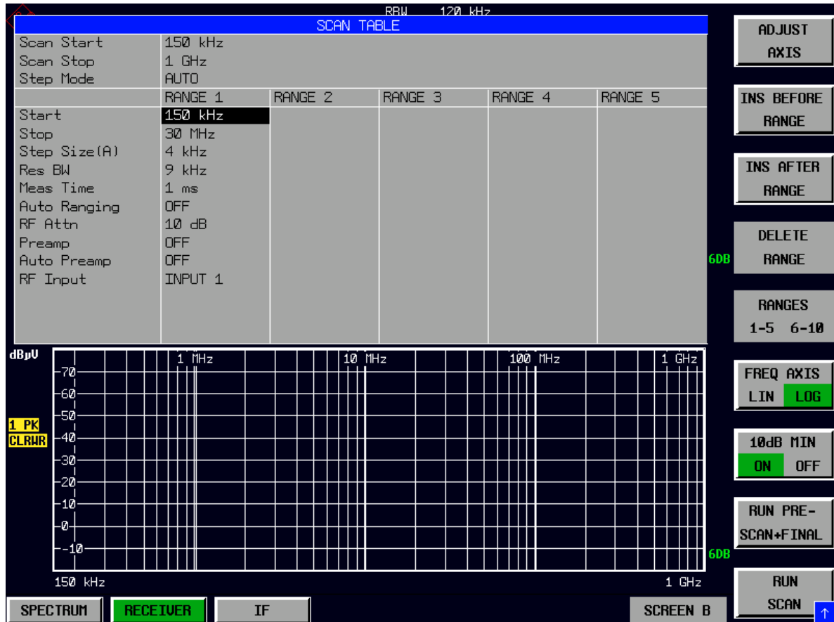
Bild 5-3 Scan-Bereich nach Auswahl des Default-Setups mit PRESET
